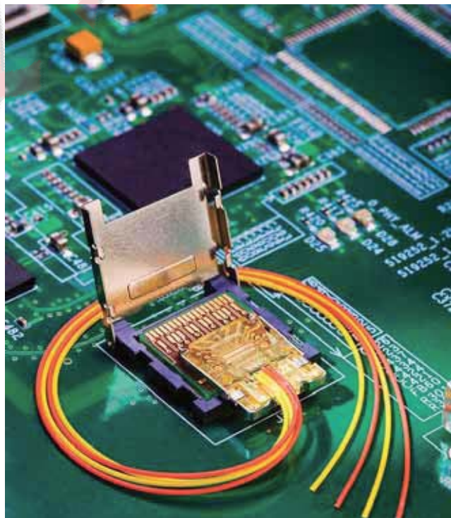
Light Peak 光模块支持四根光纤, 每根支持 10Gbps 数据速率。初期版本的 Light Peak 将支持 10Gbps, 但 Intel 设计可提高到 100Gbps。
