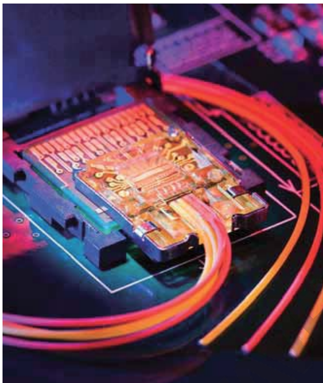
据 Intel 说，120 个如图所示的 Light Peak 光模块，可以放进一个传统电信模块的体积内。模块仅仅为 12×12mm。
