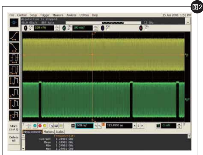
图 2 突发数据的示波器截图。
