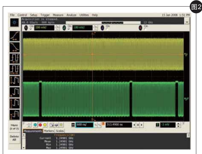
图 2 突发数据的示波器截图。
